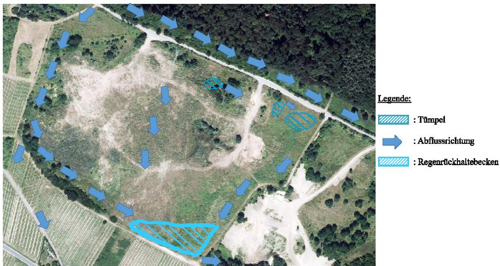
Abbildung 40. Geplante Wasserableitung (Mapbender, 2016) geändert 2018 von B.Hermann
